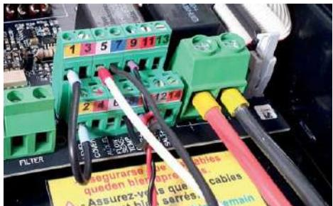
Connexion avec le capteur de débit de la cellule (effet pile), sans capteur de débit
